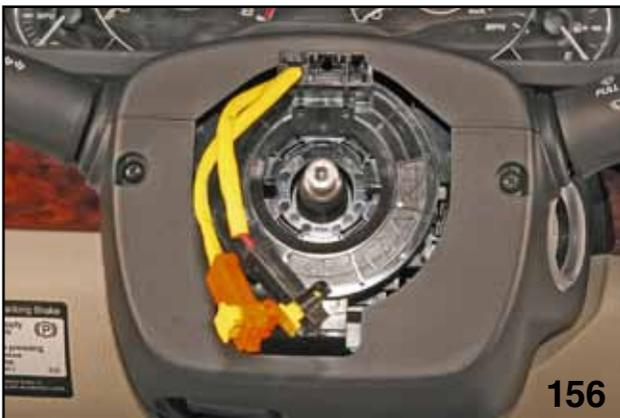
*STEERING ROLL CONNECTOR AND AIRBAG CONNECTORS*
