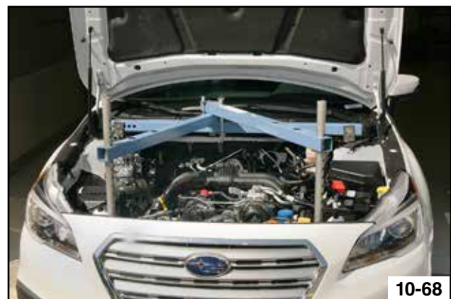
LH Longitudinal Bar Installed
