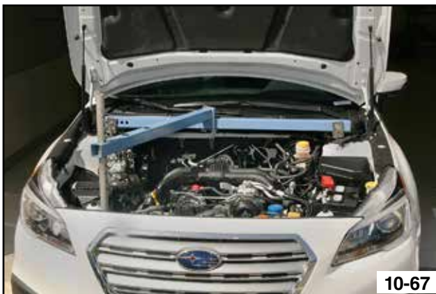
RH Longitudinal Bar Installed
