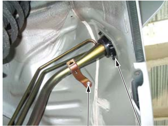
FUEL FILL PIPE BRACKET BOLT
