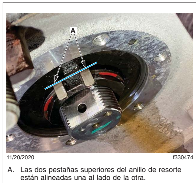
Fig. 2, Lengüetas superiores del anillo de resorte instaladas correctamente
