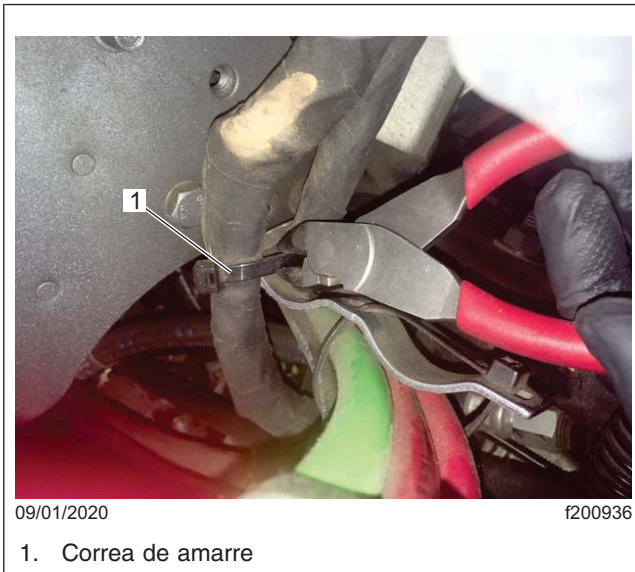
Fig. 1, Extracción de la correa de amarre del arnés
