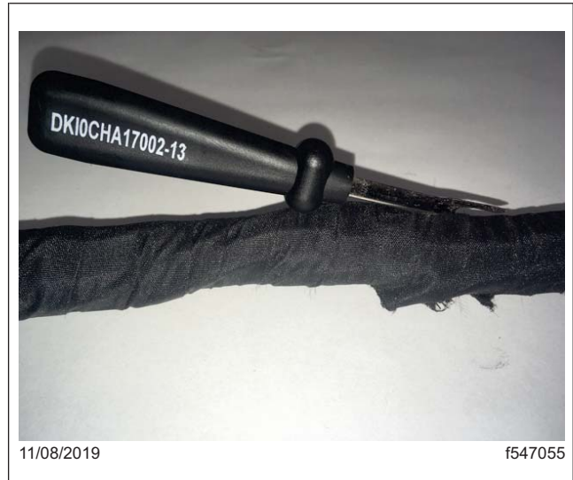
Fig. 5, Corte de la envoltura de fibra con el extremo romo de la herramienta para romper costuras
