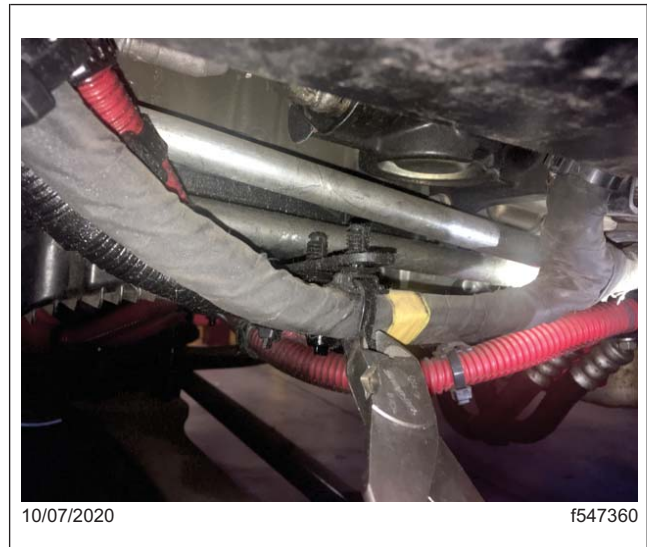
Fig. 2, Extracción de la correa de amarre del arnés
