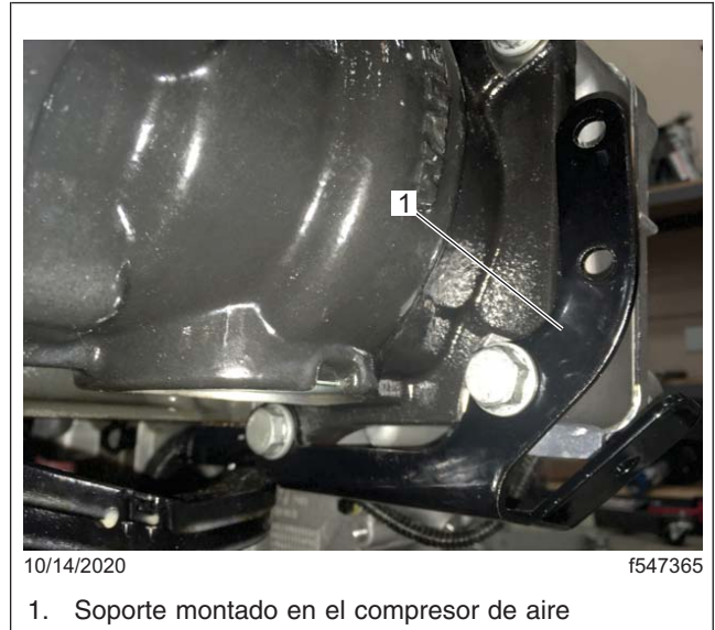
Fig. 14, Soporte montado en el compresor de aire nuevo
