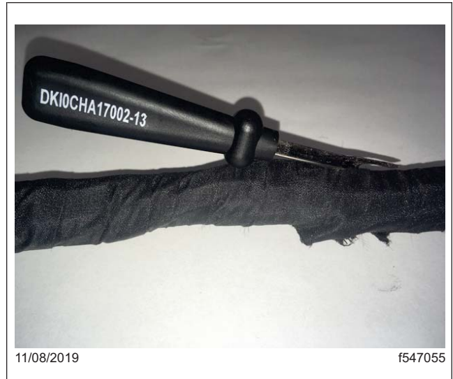
Fig. 5, Découpe de l'enrobage en fibres à l'aide de l'extrémité émoussée du découpeur
