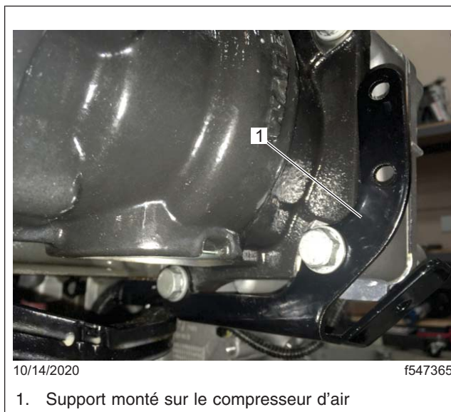
Fig. 14, Nouveau support monté sur le compresseur d'air
