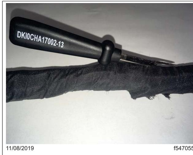
**Fig. 4, Corte de la fibra con el extremo romo de la herramienta para romper costuras**
