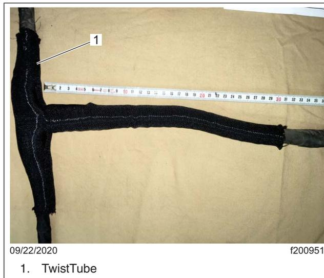
**Fig. 23, Medición vertical TwistTube**
