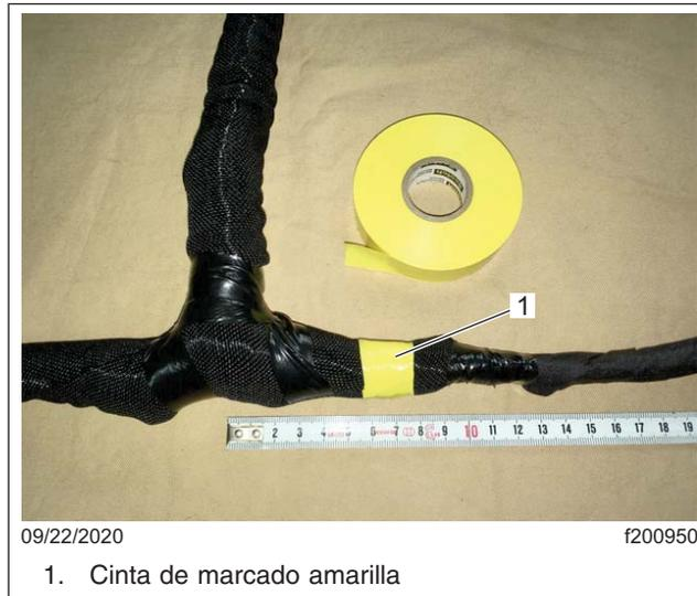
**Fig. 24, Cintas de marcado amarillas para la sección horizontal**
