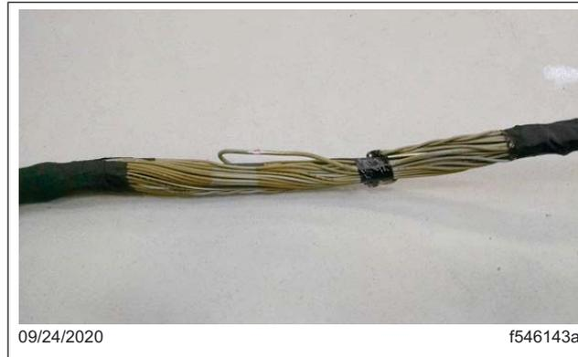
**Fig. 20, Superposición agregada al área dañada del arnés**
