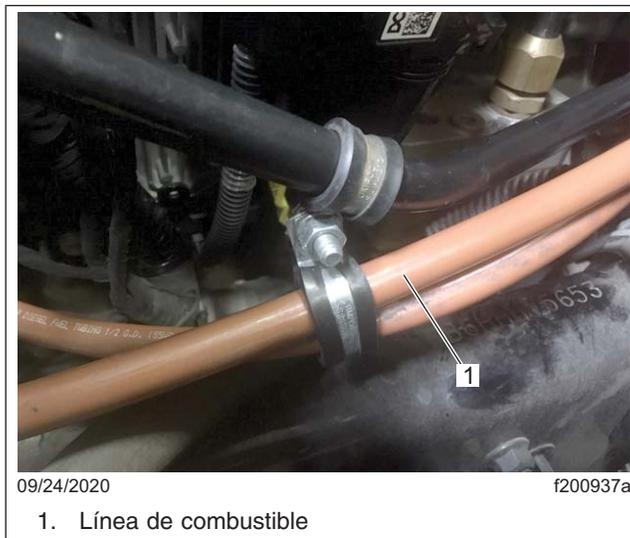
**Fig. 29, Fijación de la línea de combustible**
