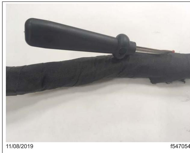
**Fig. 3, Corte de una abertura en la envoltura de fibra**
