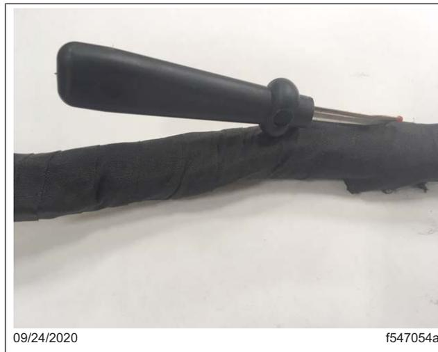
**Fig. 17, Corte de una abertura en la envoltura de fibra**
