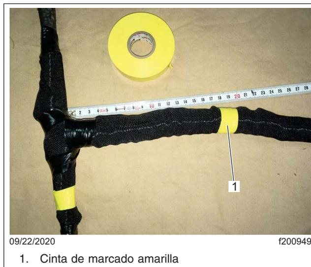
**Fig. 25, Cintas de marcado amarillas para la sección vertical**
