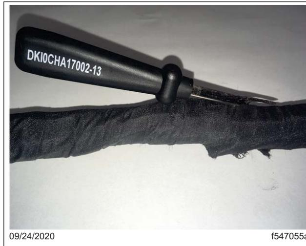
**Fig. 18, Corte de la fibra con el extremo romo de la herramienta para romper costuras**
