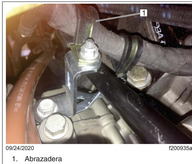
**Fig. 27, Instalación de la abrazadera**
