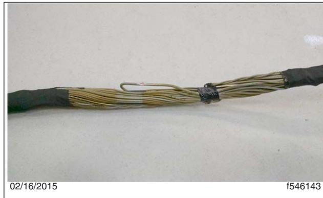
**Fig. 6, Superposición agregada al área dañada del arnés**
