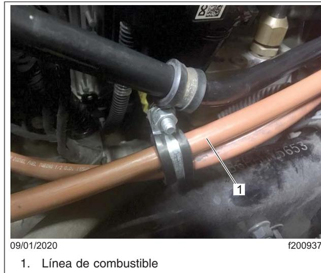
**Fig. 14, Fijación de la línea de combustible**
