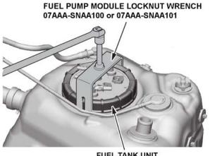
FUEL TANK UNIT LOCKNUT Loosen.
