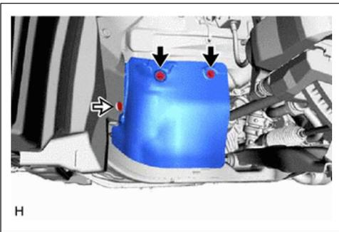
**3. INSTALL FRONT FENDER APRON SEAL LH & RH**
