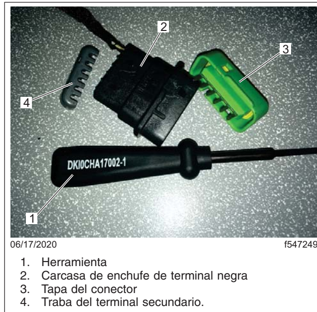
Fig. 7, Extracción del paquete de empalme
