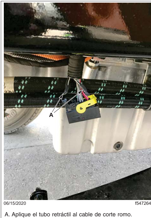
Fig. 16, Tubo retráctil aplicado
