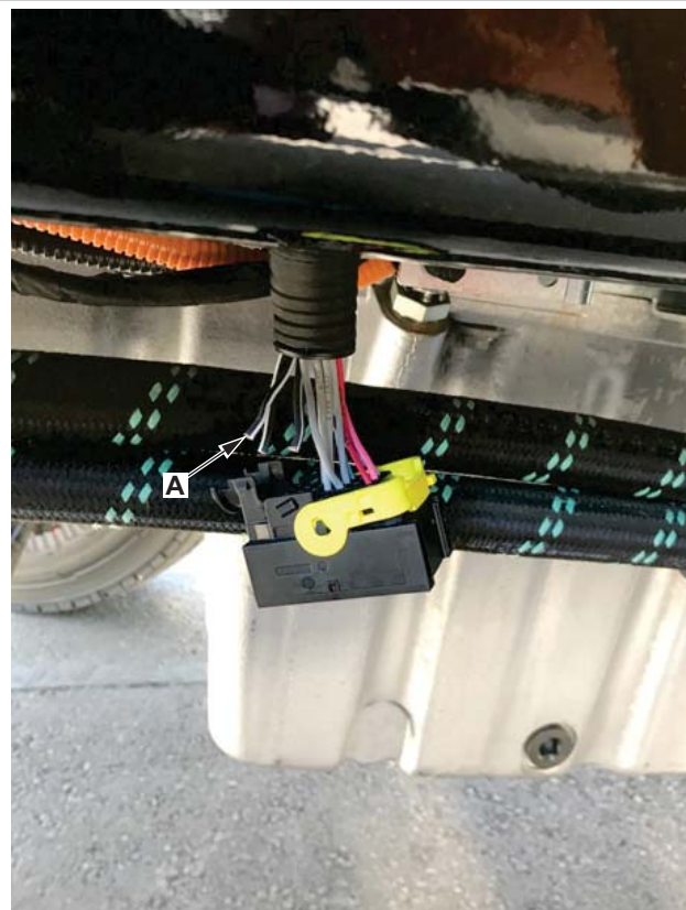
Fig. 15, Cable de corte roto
