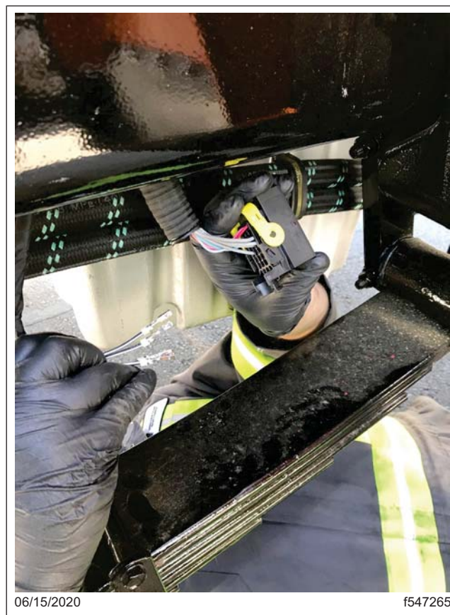
Fig. 18, MCM de 21 clavijas con nuevos terminales
