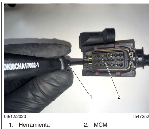
Fig. 13, Liberación del bloqueo secundario del MCM
