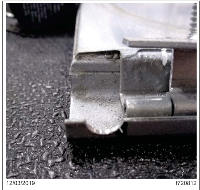
Fig. 2, Trimmed Baggage Door Flange
