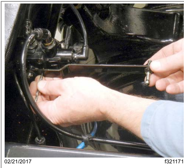
Fig. 7, Goupillage du levier de soupape
