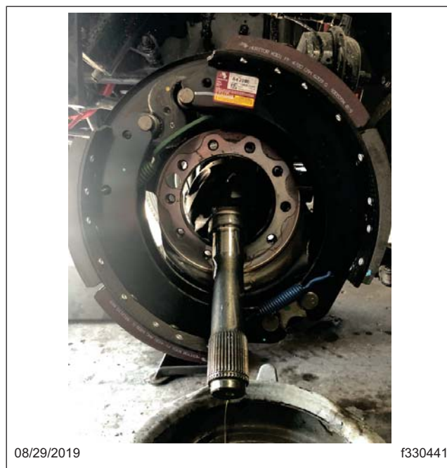
Fig. 20, Fusée retirée de l'ensemble
