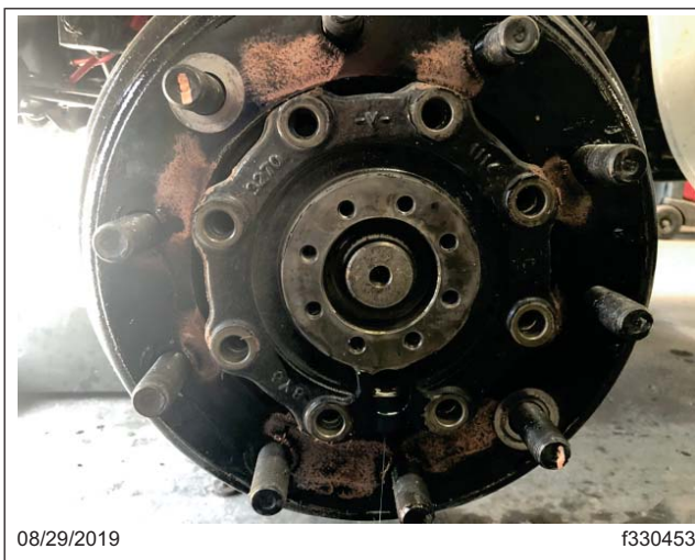
Fig. 7, Boulons de colerette connectant la colerette de direction au moyeu de roue retirés
