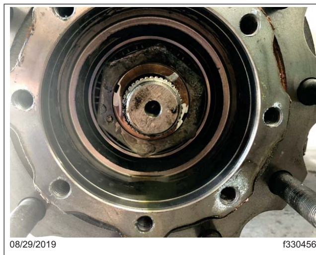
Fig. 11, Anneau de blocage retiré
