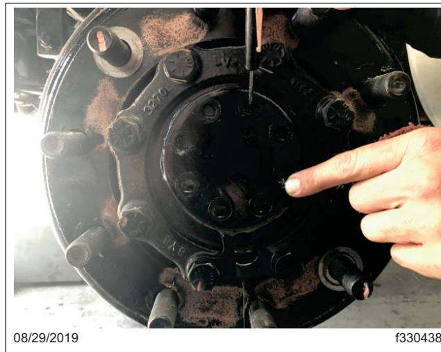
Fig. 2, Boulons du couvercle de moyeu retirés
