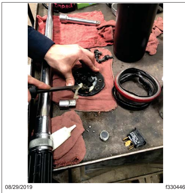
Fig. 27, Nettoyage du couvercle de moyeu
