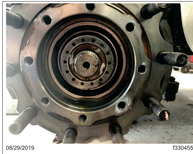
Fig. 10, Écrou de fusée extérieur enlevé
