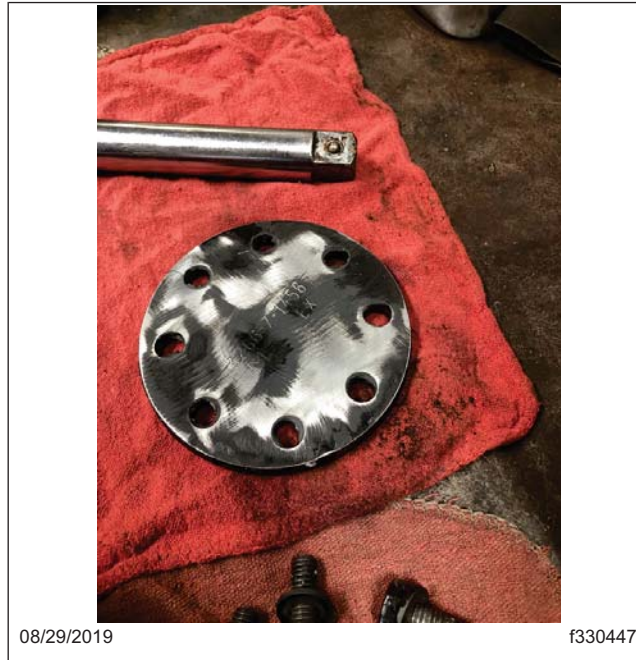
Fig. 28, Couvercle de moyeu nettoyé
