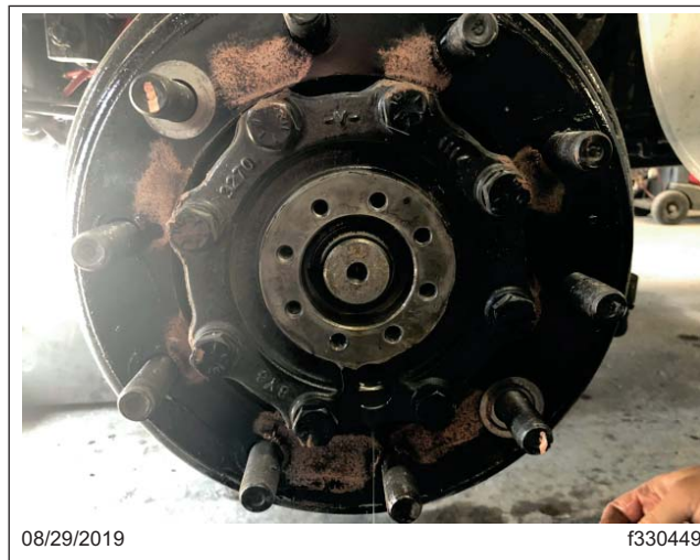
Fig. 3, Couvercle du moyeu retiré
