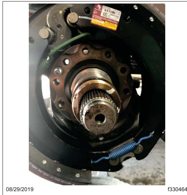
Fig. 19, Boulon de fixation de la collerette retiré
