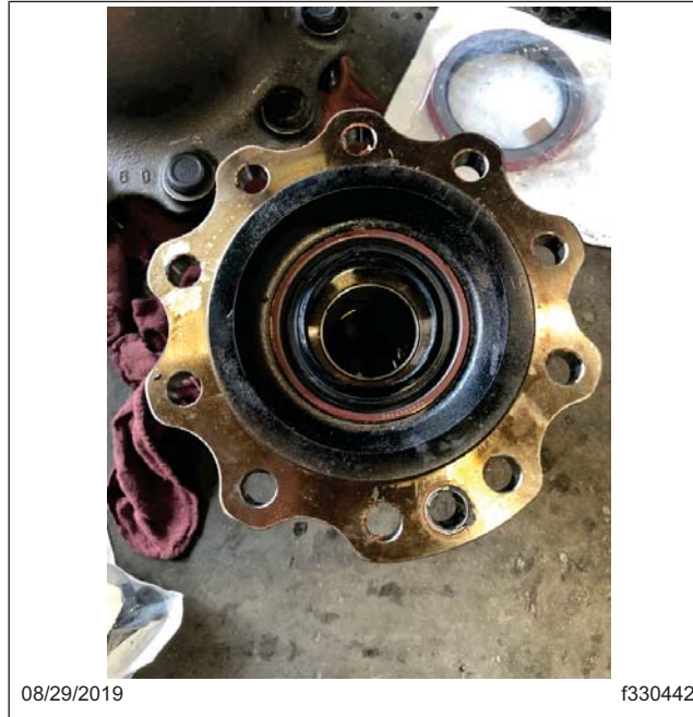
Fig. 22, Joint de fusée installé
