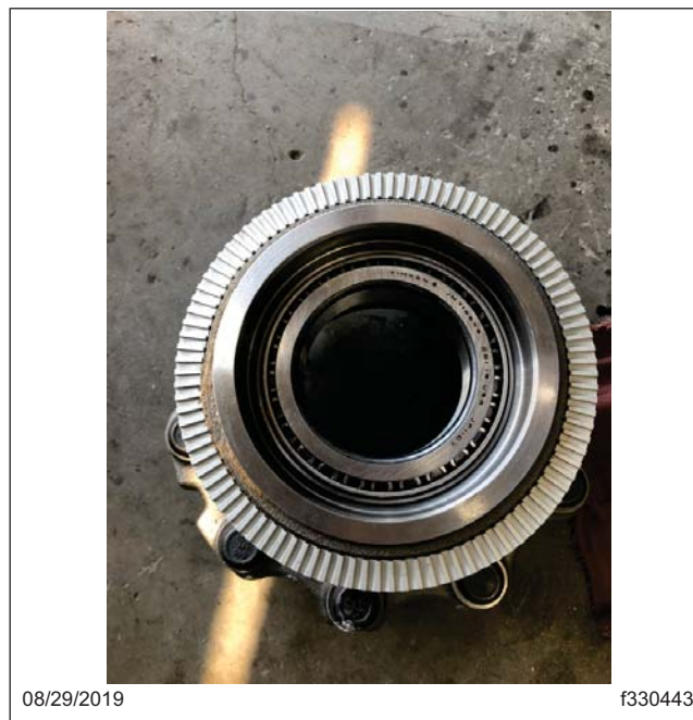
Fig. 24, Nouveau coussinet de roue intérieur lubrifié
