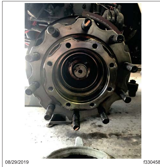
Fig. 13, Coussinet extérieur retiré
