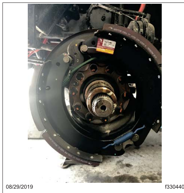
Fig. 14, Moyeu et coussinet intérieur retirés
