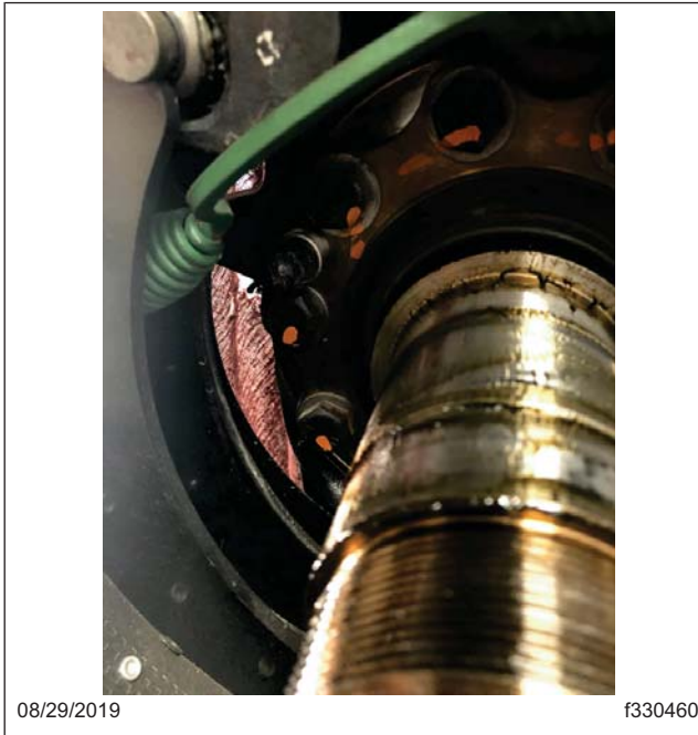
Fig. 15, Retrait du capteur des freins ABS
