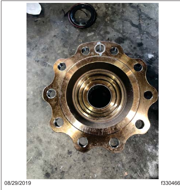
Fig. 21, Installation du joint de fusée
