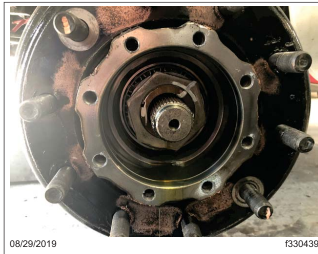
Fig. 8, Collette de direction du moyeu retirée
