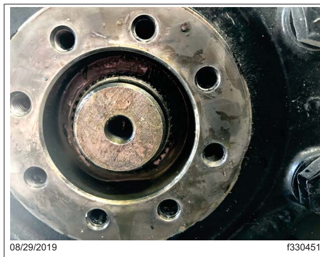
Fig. 5, Anneau élastique retiré de l'arbre d'essieu
