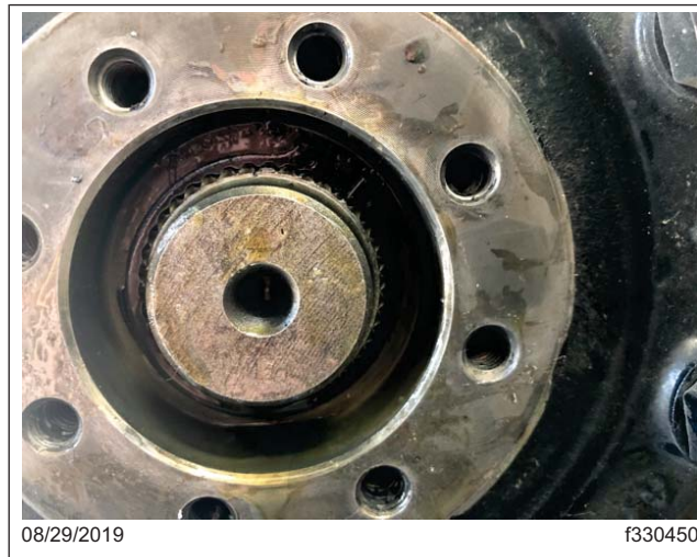
Fig. 4, Arbre d'essieu avec anneau élastique
