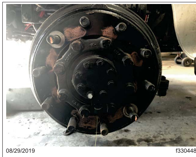
Fig. 1, Bouchon de vidange/remplissage d'huile retiré
