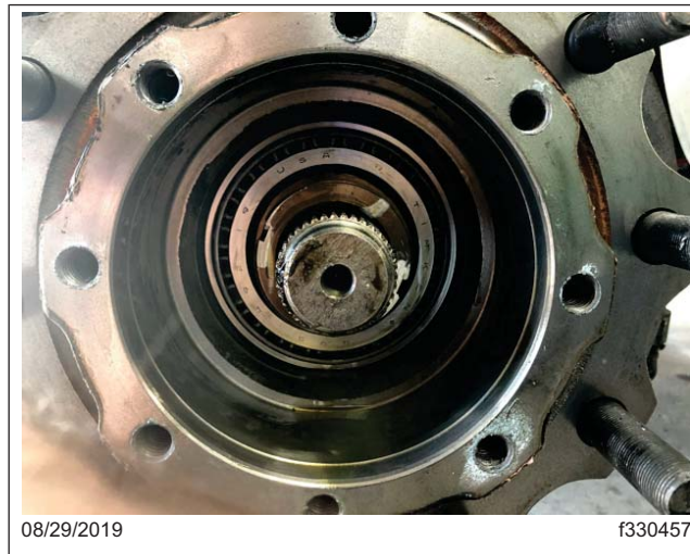
Fig. 12, Écrou de fusée intérieur enlevé
