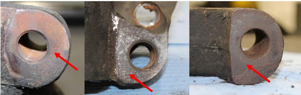
**Figure 2 – Usure qui pourrait ressembler à de la rouille causée par une infiltration d'eau en raison d'un joint lâche.**
