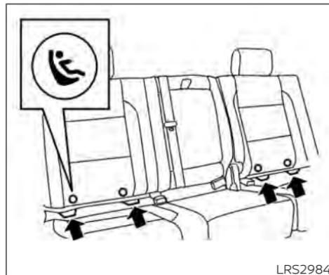
**Emplacement des étiquettes du système LATCH (modèles Crew Cab)**
