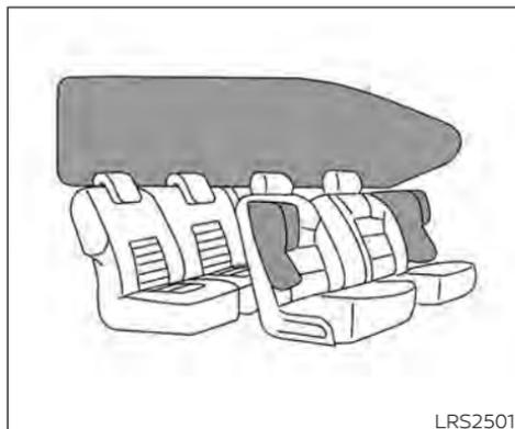
Sacs gonflables latéraux montés dans les sièges avant et rideaux gonflables latéraux et sacs gonflables en cas de renversement montés dans le toit
