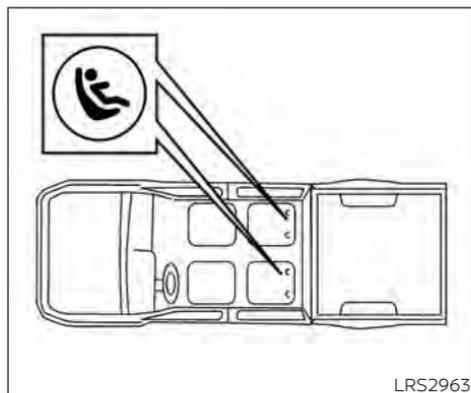
**Emplacement des points d'ancrage inférieurs du système LATCH (modèles King Cab<sup>MD</sup>)**
