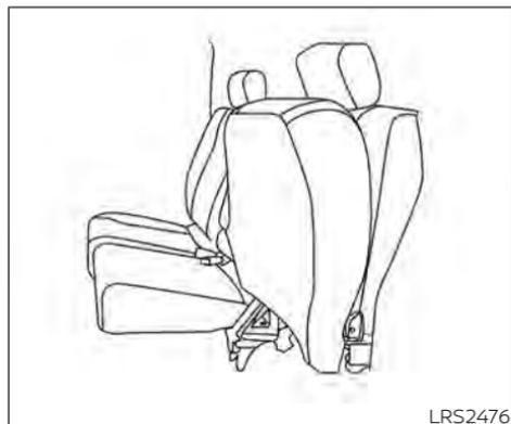
2. Relevez le bas du coussin de siège vers l'arrière du véhicule jusqu'à ce qu'il se bloque.
