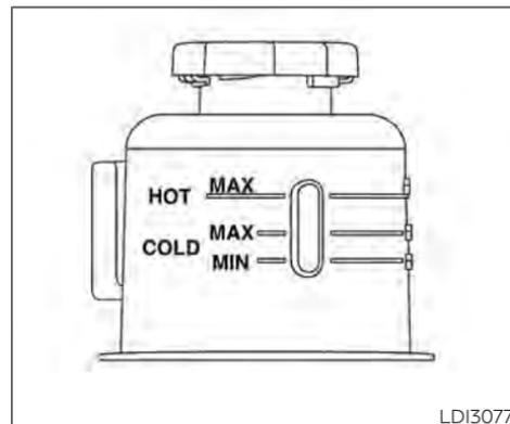
Vérifiez le niveau de liquide de direction assistée lorsque le moteur à essence est arrêté.
