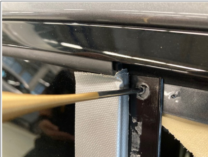
5 Loch von Innen und Außen verschließen.jpg
