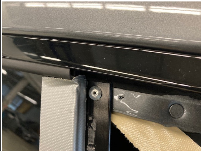
3 Nietkopf abbohren und Späne absaugen.jpg
