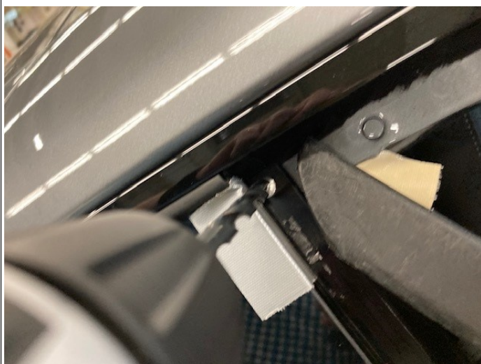
4 Durchschlag d=3mm den Niet nach innen durchtreiben.jpg
