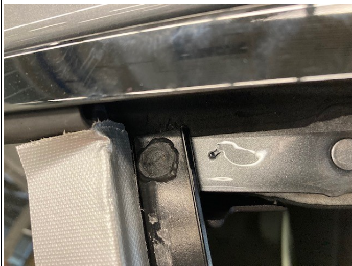
5 Loch von Innen und Außen verschließen.jpg
