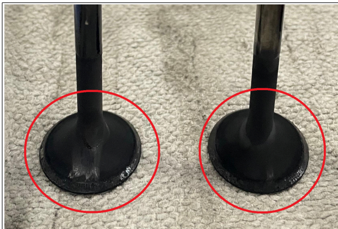
Auslassventilsitz stark verkohlt.png
