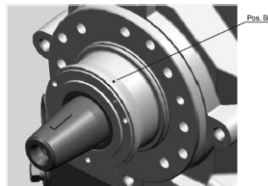
Abb. 3 Austrittsbohrung Leckageöl am Abschlussdeckel Fig. 3 Exit hole for leakage oil at the sealing cover Fig. 3 L'orifice de sortie pour l'huile de fuite dans le couvercle de fermeture
