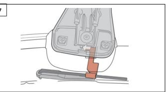
Faites glisser l'outil sur le côté pour faire glisser le crochet derrière la languette du cache
