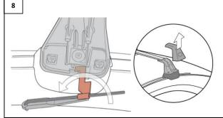
Tournez l'outil en utilisant la clé Allen comme poignée pour pousser l'arrière de l'outil contre le L et le crochet contre la languette du cache jusqu'à ce que la languette se détache.
