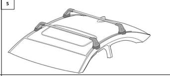
Fixez les attaches de l'étai au cache. Abaisser les caches d'extrémité sur la traverse et faire glisser vers l'extérieur pour engager les languettes. Tourner le cache vers le bas pour l'enclencher complètement en position.
