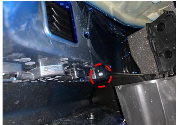
De l'intérieur, localisez et retirez la vis à tête cruciforme fixant le cache des feux de brouillard. Conserver la vis pour la réinstallation
