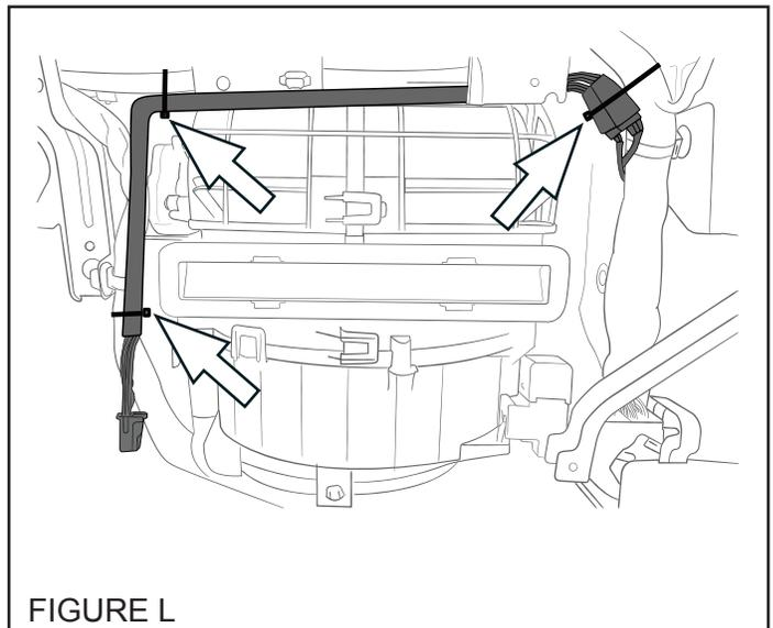
5. Branchez le connecteur à 12 broches du faisceau cavalier prémonté dans la prise blanche à 12 broches de l'UCE du démarreur à distance, précédemment monté sur l'envers du couvercle intérieur de la boîte à gants (étape 5).
