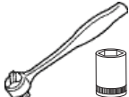
Clé à rochet, douilles de 10 et 12 mm, rallonge et joint à rotule
