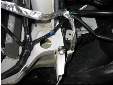
Utilisez l'attache noire pour relier le harnais du chauffe-moteur au harnais du véhicule. Laissez environ un pouce de jeu pour le harnais afin de permettre le mouvement du moteur.
