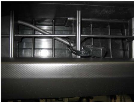
En utilisant la sangle de protection de la prise mâle, attachez la prise mâle à la calandre dans la partie inférieure de l'admission d'air.
