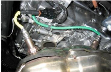
**(Photo A)** Descendre doucement le système d'échappement, mais ne pas l'enlever.
