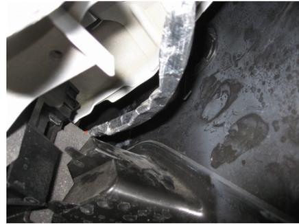
Dirigez le harnais du chauffe-moteur en avant du conduit variable et derrière le support vertical de l'ouverture d'admission d'air inférieure
