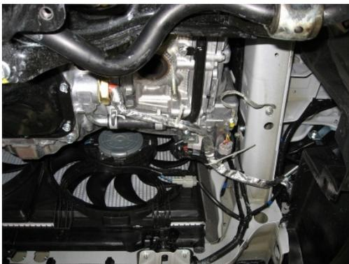
Dirigez le harnais vers le rebord du longeron du cadre du châssis côté droit vers l'avant du véhicule.
