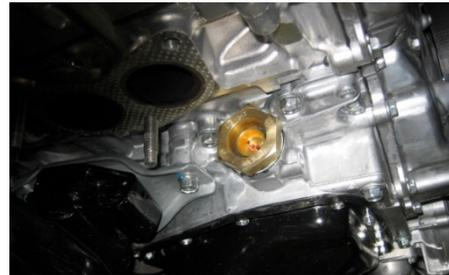
Installez le chauffe-moteur dans l'ouverture du bouchon expansible et serrez avec les pinces ajustables jusqu'à ce que le joint d'étanchéité soit bien assis sur le bloc-moteur. <Information de référence> La valeur de la couple de serrage de la prise du chauffe-moteur : 90[N.m] / 66.4 [lb.pi].
