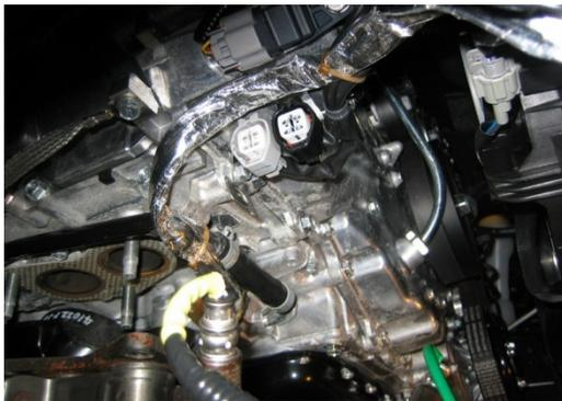
En utilisant l'attache métallique or haute température fournie, reliez le harnais du chauffe-moteur à la section recouverte de ruban aluminium de la ligne du liquide de refroidissement de la transmission CVT. Dirigez le harnais vers l'avant au-dessus des connecteurs électriques du capteur d'oxygène. Utilisez la deuxième attache métallique or haute température pour relier le harnais du chauffe-moteur au harnais du moteur près du connecteur noir du capteur d'oxygène.
