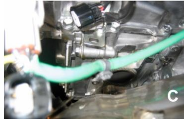
**(Photo B& C)** Débranchez les deux harnais de fils du capteur d'oxygène et libérez un harnais de fils du capteur d'oxygène de son lieu de montage.
