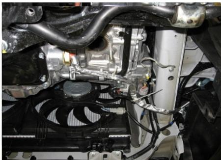
Branchez le harnais dans l'élément du chauffe-moteur. Dirigez le connecteur orange vers l'avant en le tournant à l'intérieur du chauffe-moteur. L'intérieur du chauffe-moteur peut être orienté selon le boîtier extérieur.
