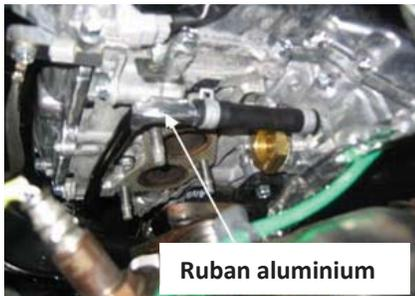
En utilisant le ruban aluminium fourni, enveloppez la ligne de liquide de refroidissement de la transmission à variation continue près du point où il s'attache à la durite.
