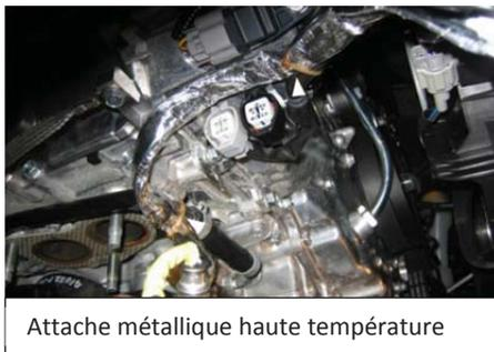
En utilisant une attache métallique or haute température fournie, fixez le câblage du chauffe-moteur à la section recouverte de ruban aluminium de la ligne de liquide de refroidissement de la transmission à variation continue. Dirigez le câblage vers l'avant au-dessus des connecteurs électrique du capteur d'oxygène. Utilisez la deuxième attache métallique or haute température pour fixer le câblage du chauffe-moteur au câblage du moteur près du connecteur noir du capteur d'oxygène.
