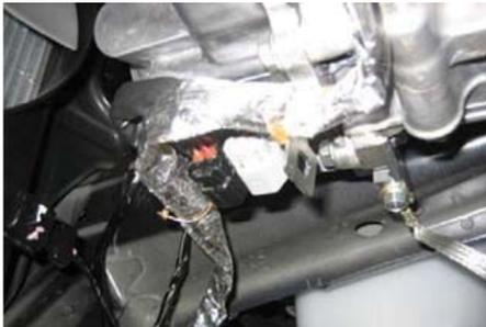
Fixez le câblage du chauffe-moteur au support du capteur d'oxygène et au câblage du moteur en utilisant les deux attaches métalliques or haute température inclus dans l'ensemble.
